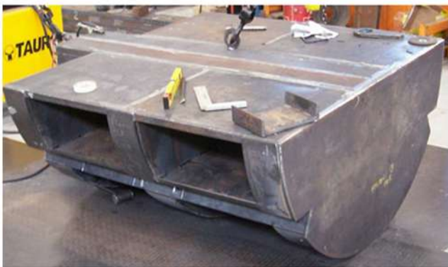
Parte inferior de la placa de compactación en proceso de fabricación.
